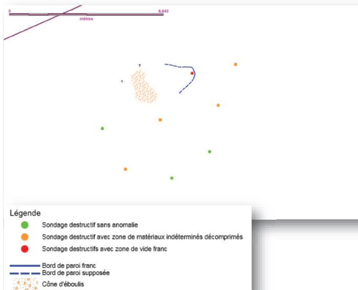
Schéma 11 : Esquisse de la cavité souterraine à partir des mesures télémétriques
