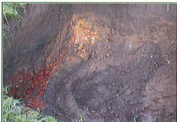
Le suivi d'opérations de décapage et de sondage à la pelle permet, à moindre frais, d'identifier l'origine d'une anomalie et de localiser en particulier le puits d'accès d'une ancienne exploitation souterraine.
